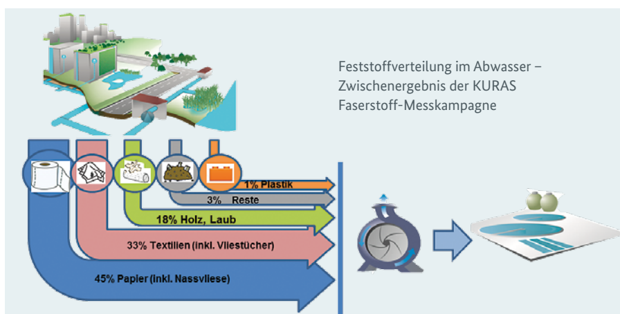
Abb. 2: Feststoffverteilung im Abwasser (Auszug aus den Zwischenergebnissen der Feststoffmesskampagne im Rahmen von KURAS). Quelle: Projekt KURAS
