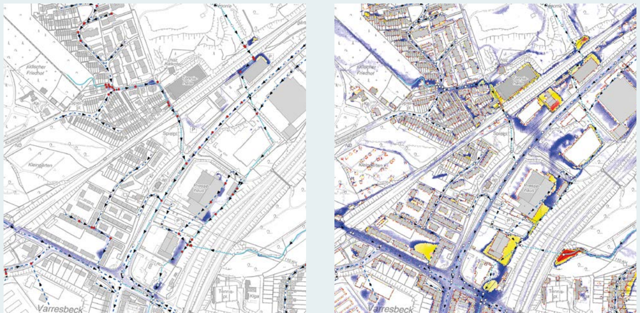
Abb. 5a und 5b: Überflutungssimulation für das Modellgebiet im IST-Zustand für T=30a mit Abflussbildung über das Kanalnetzmodell (links) und Abflussbildung über das Kanalnetz- und Oberflächenmodell (rechts). Quelle: Dr. Pecher AG 2016
