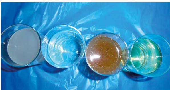
Abb. 2: Grauwasser, Betriebswasser, Schwarzwasser, Flüssigdünger (v. l. n. r.). Quelle: Nolde & Partner
