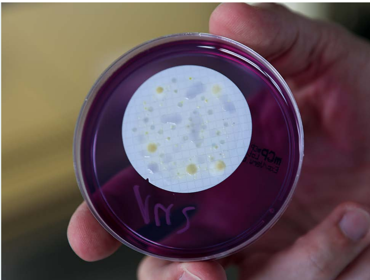
Abb. 1: Heutiger Stand der Technik ist der Nachweis ausgewählter Indikatororganismen durch verschiedene Varianten des Kulturverfahrens, hier am Beispiel des Trinkwasserlabors der Berliner Wasserbetriebe. Foto: Daniel Karthe
